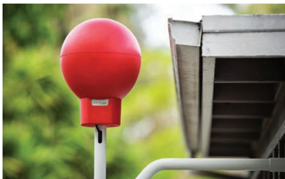
Рис. 3. Модем для выхода в интернет через воздушные шары Google Loon установлен на крыше дома одного из участников эксперимента
